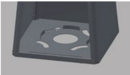
Figura 8: Desenho geral dos suportes inferiores de um cilindro de gás ao qual o cilindro deve ser fixado após a instalação.
